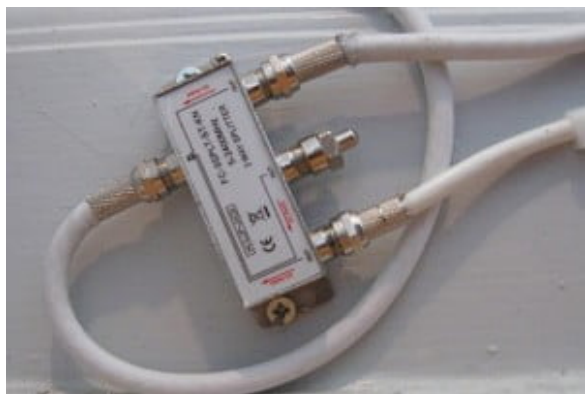
Antennefordeler med tre udgange.
