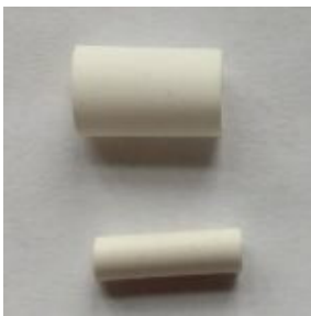
Krympeflex før og efter opvarmning.
